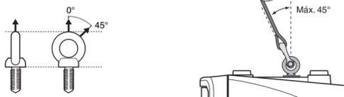
Incorrecto: No suspenda los cáncamos como se muestra en la ilustración de abajo.
