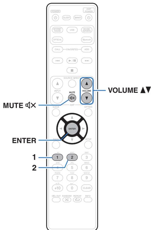
El modo de funcionamiento mediante el mando a distancia puede cambiarse para activar el ajuste de audio en la unidad principal si la salida de audio analógico de la unidad principal (VARIABLE) se conecta al amplificador de potencia.
