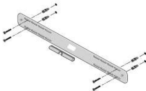
6. Coloca el soporte sobre la pared y aprieta un poco los tornillos para sujetar el soporte. Comprueba que está bien nivelado y aprieta los tornillos.
