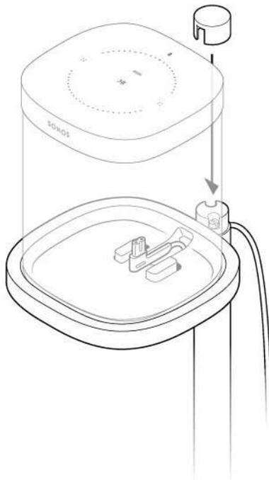
6. Presiona el cable de alimentación hacia el eje, desde arriba hacia abajo. Tira del cable sobrante hacia abajo desde la base.
