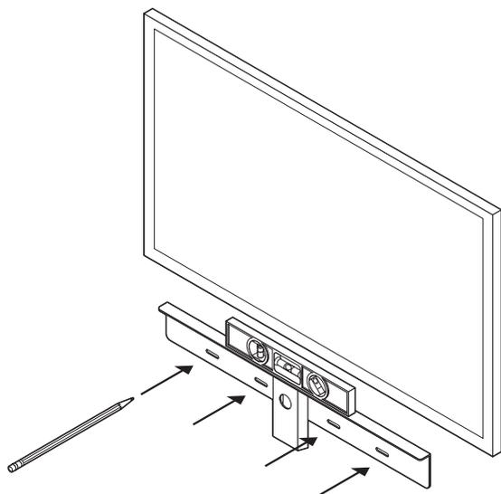
3. Utiliza una broca de 5/16" para perforar los orificios guía (consulta [Información para el montaje en pared](#)).
