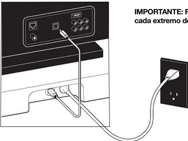
**IMPORTANTE:** Retira las tapas protectoras de cada extremo del cable de audio óptico.
