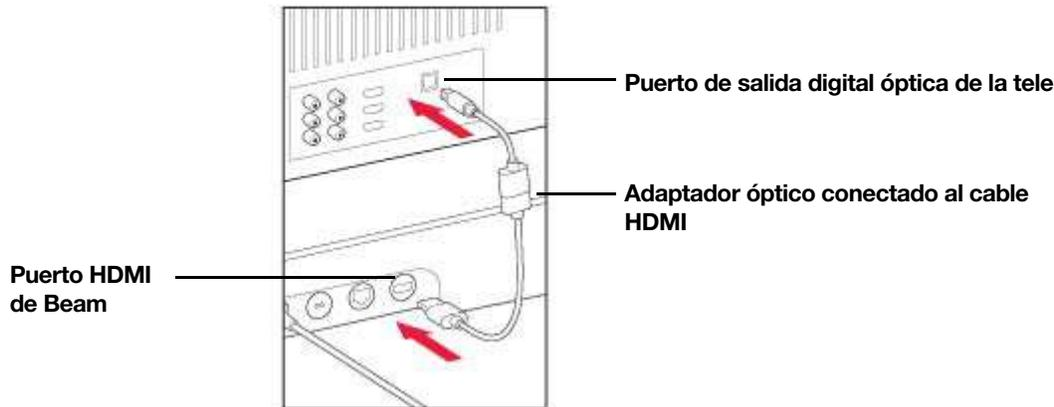
**Nota:** El puerto del adaptador óptico tiene forma de D. Asegúrate de que el conector está bien conectado en el puerto. Si insertas el adaptador de forma incorrecta, podrías estropear el cable.
