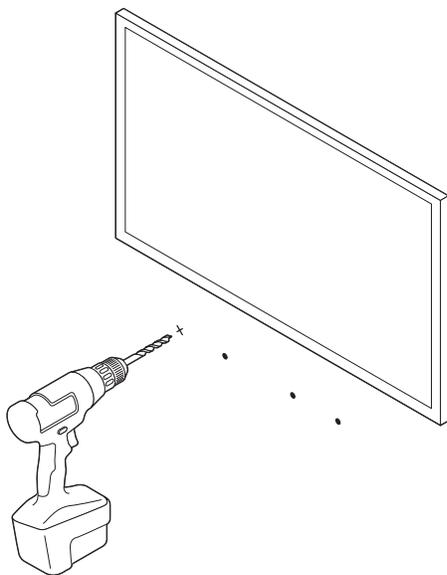
4. Inserta y fija los tacos (no uses los tacos si perforas en madera).
