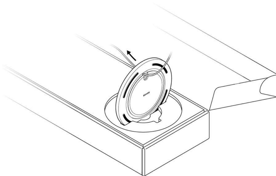
2. Ajusta el eje en la base usando las clavijas de alineación para colocar el surco del cable de alimentación en la parte delantera o trasera. Usa los dos tornillos negros y un destornillador de estrella para fijar la base.
