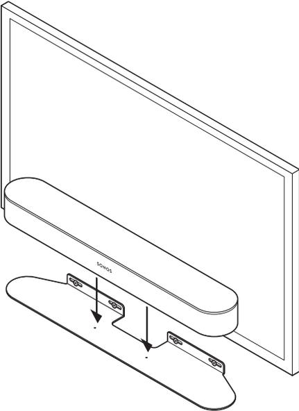
8. Inserta y aprieta Beam en el soporte utilizando los tornillos de montaje.
