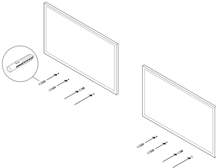
5. Coloca el soporte sobre la pared y aprieta un poco los tornillos de la pared para sujetar el soporte. Comprueba que está bien nivelado y aprieta los tornillos.
