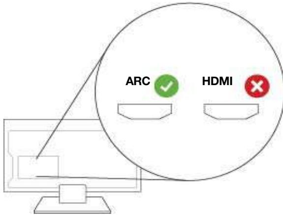
2. Conecta el cable HDMI al puerto **HDMI ARC** de la tele.
