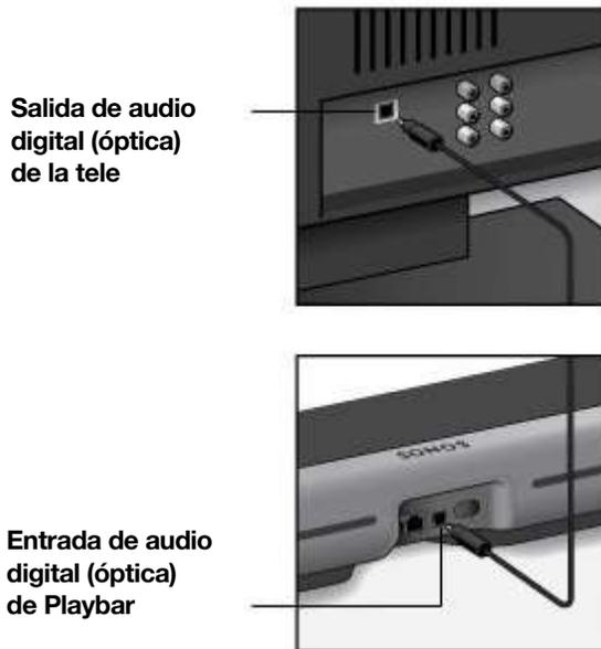
**IMPORTANTE:** Retira las tapas protectoras de cada extremo del cable de audio óptico antes de insertarlo.
