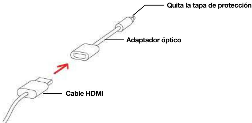
3. Conecta el adaptador óptico al puerto de **salida digital óptica** de la tele.
