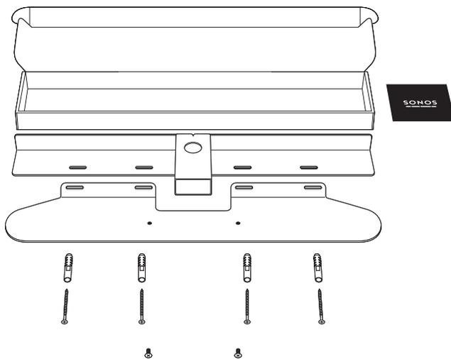
1. Pega la plantilla de cartón en la pared por encima o por debajo de tu tele. Utiliza un nivel. Mantén al menos 2,5 cm de espacio libre encima de Beam para poder llegar a los controles táctiles. (No coloques Beam en posición vertical).
