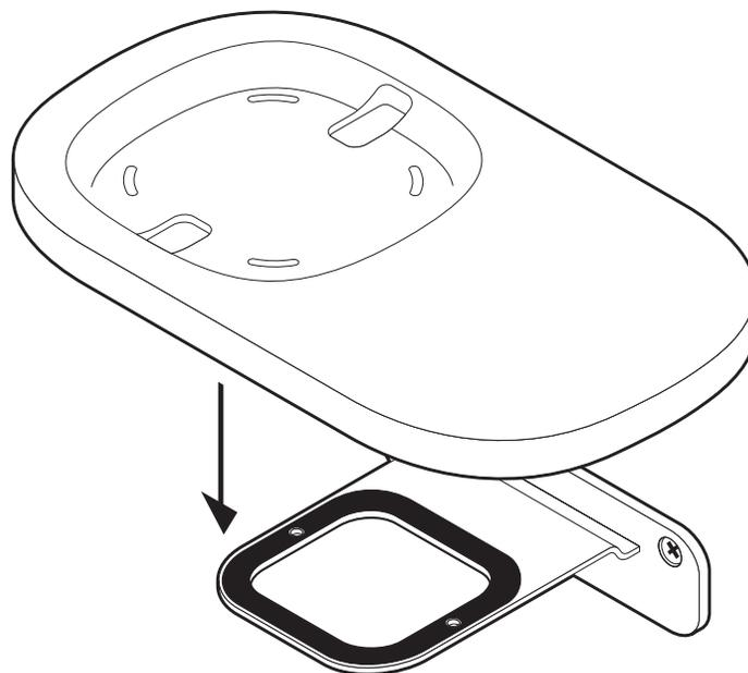
5. Desliza el cable de alimentación del altavoz a través de la abertura del estante. (Una vez montado, enrolla el cable alrededor de la parte inferior del estante).
